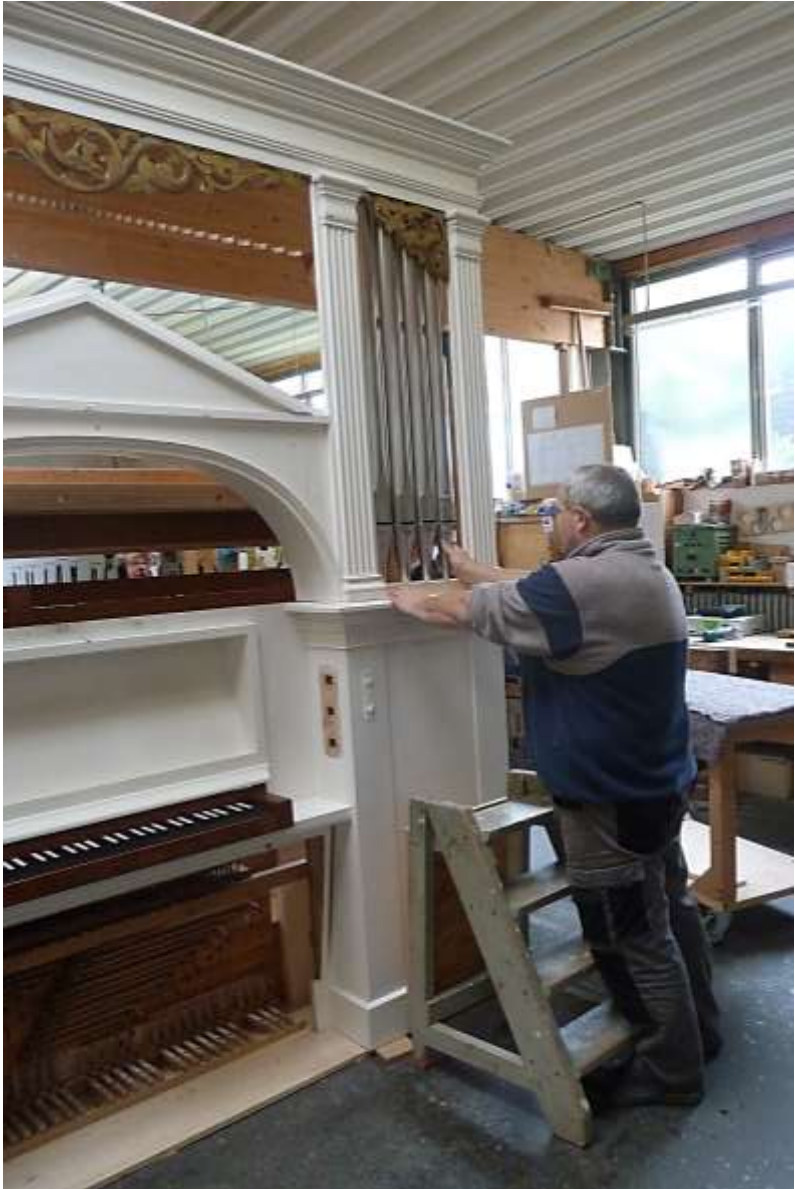
Die neuen Prospekt Pfeifen werden eingepasst
