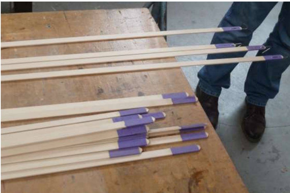
Holzstäbe, die die Tasten mit den Pfeifen verbinden
