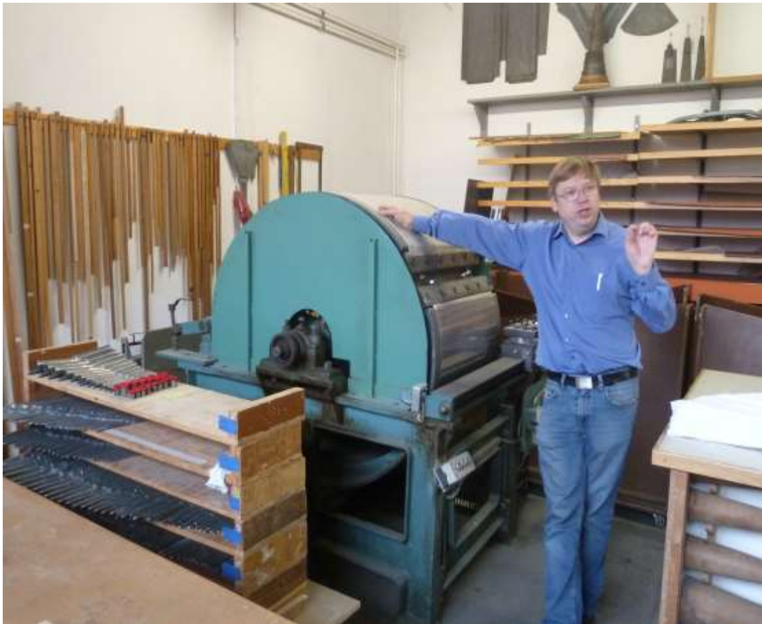
Walze zum Walzen des Blechs für die Pfeifen
