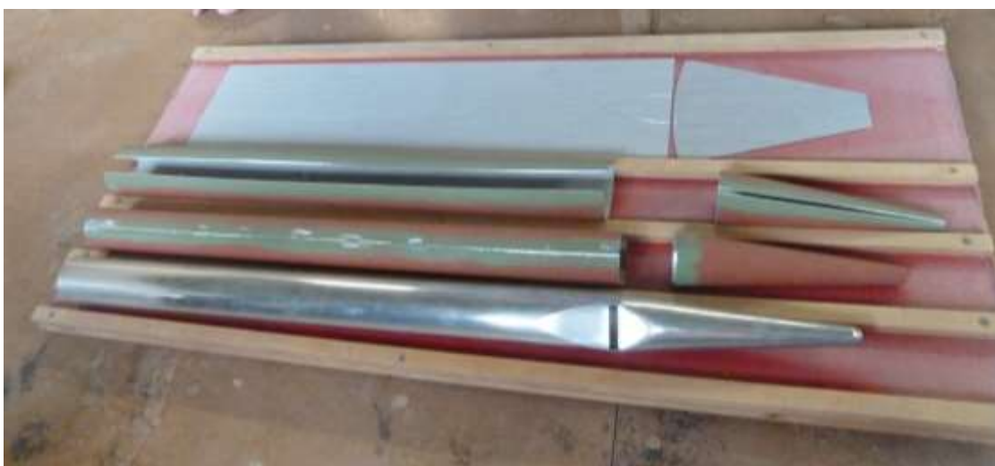
Die einzelnen Schritte der Entstehung einer Pfeife
